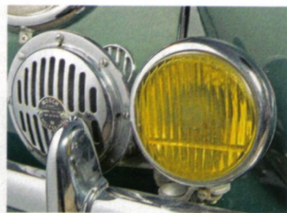
Starktonhörner und Nebelscheinwerfer mit gelben Gläsern von Bosch.
