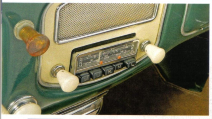
Das etwas jüngere Blaupunkt-Radio steckt im VW-Nachrüst-rahmen für Brezel-Käfer.
