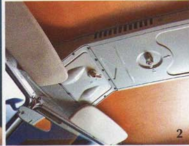
1. 230 Volt-Anschluss an das Stromnetz des Campingplatzes über dem Rücklicht. 2. Frischluftanlage mit raren, zuschaltbaren Elektrolüftern. 3. Große 1,90 x 1,47 Meter breite klappbare Liegefläche im Wagenheck. 4. Der jetzige 1600er Motorblock wird demnächst wieder gegen den überholten Originalmotor mit 1500 ccm getauscht.
