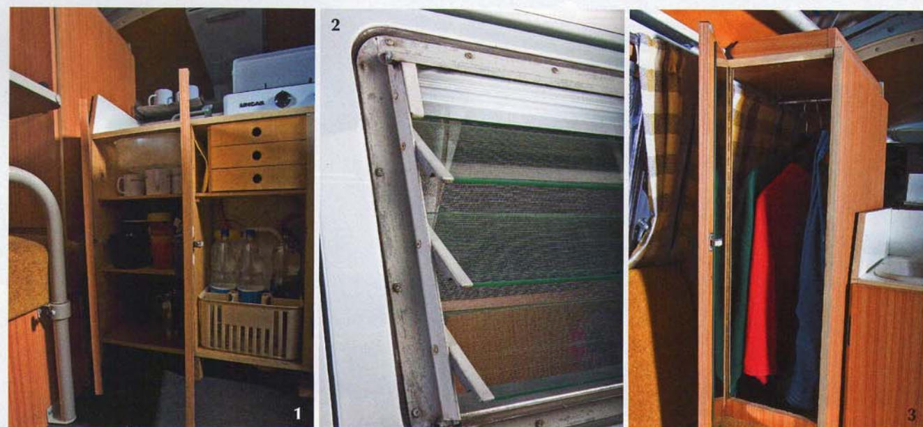
1. Stauraum in Hülle und Fülle zählt zu den herausragenden Attributen des SO 44-Ausbaus. Die Küchenutensilien wie Geschirr und Gewürze finden Platz im großen Küchenblock an der Trennwand. 2. Lamellenfenster sorgen für frische Luft. 3. Großer Kleiderschrank hinter dem Fahrersitz.
