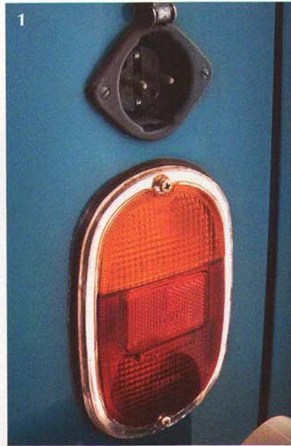
1. 230 Volt-Anschluss an das Stromnetz des Campingplatzes über dem Rücklicht. 2. Frischluftanlage mit raren, zuschaltbaren Elektrolüftern. 3. Große 1,90 x 1,47 Meter breite klappbare Liegefläche im Wagenheck. 4. Der jetzige 1600er Motorblock wird demnächst wieder gegen den überholten Originalmotor mit 1500 ccm getauscht.
