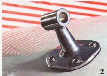
1. Der zweiflammi-ge Benzinkocher kostete 90 Mark Aufpreis. 2. Fixiert das Vorzelt – Befestigungsöse auf dem Dach. 3. Originale und unrestaurierte 65er Armaturen.
